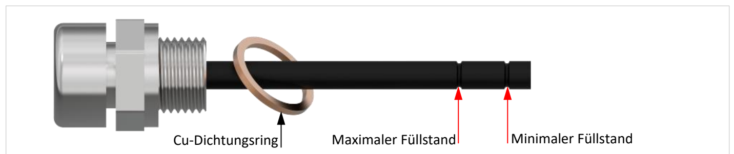
Abbildung 3.3.3: Entlüfter mit Ölpeilstab
